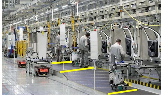
Exemple: ligne de portes / Door assembly Line
